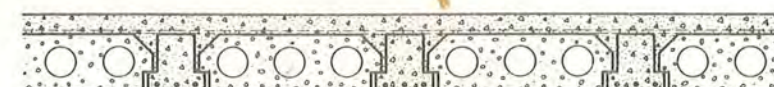
C. Klinkerbeton-hulblokdæk 5 cm overbeton, \sigma_{T,28} = 240 \text{ kp/cm}^2 250 kg/m 2 R10 pr. 25 cm Klinkerbetonhulblokke Jernbetonbjælker pr. 60 cm
